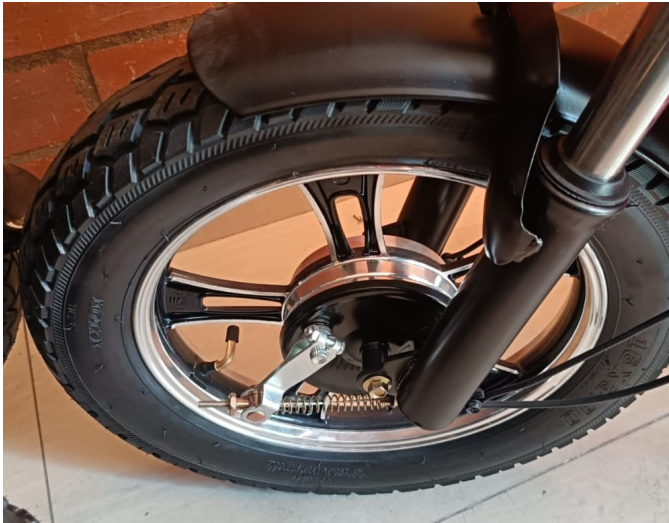
Freno de campana con su tensor de ajuste.
