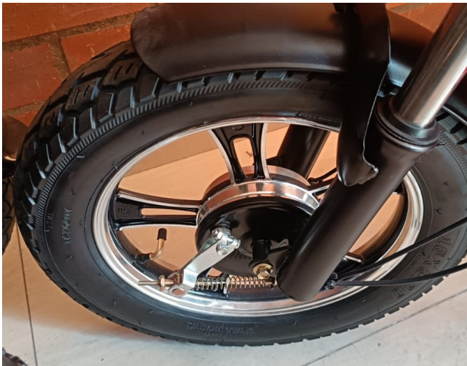
Freno de campana en la rueda delantera con su tensor de ajuste.
