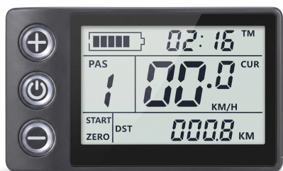
Display del manubrio: batería, nivel de asistencia (PAS), velocidad, tiempo y distancia.
