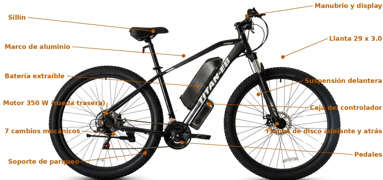
Partes principales de la Todo Terreno rin 29 llanta ancha 3.0.
