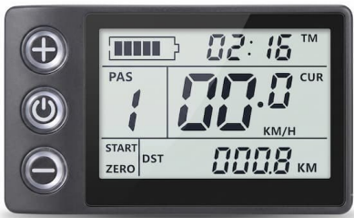
Display de la bicicleta: batería, nivel de asistencia, velocidad y distancia.
