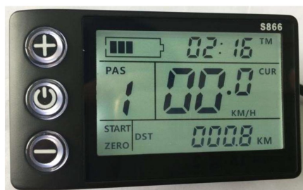
Display S866: batería, nivel de asistencia (PAS), velocidad y distancia
