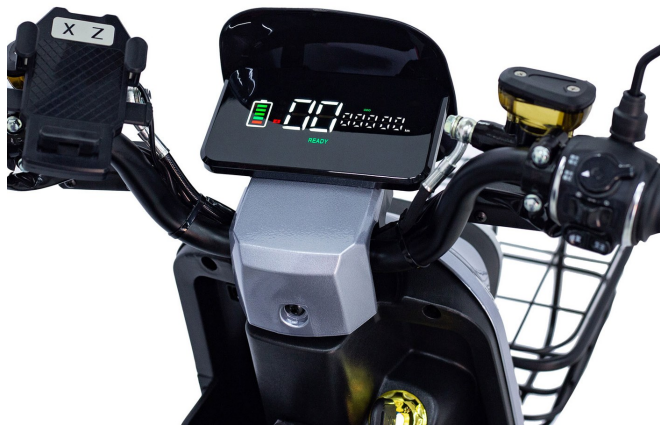
Display de la bicicleta: nivel de batería, velocidad, odómetro e indicador READY
